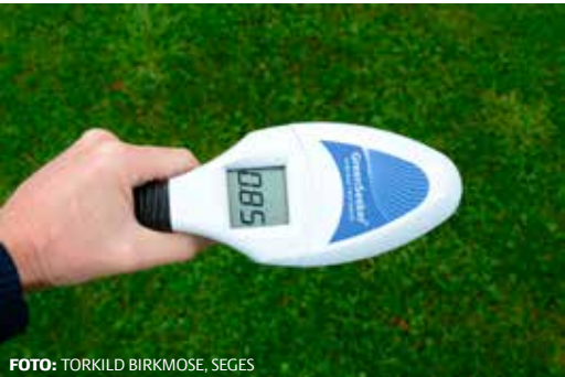
FOTO: TORKILD BIRKMOSE, SEGES En GreenSeeker kan hurtigt og let måle afgrødens biomasse i form af en NDVI-måling, og målingen kan bruges til at justere afgrødes kvælstofbehov i vækstsæsonen.
